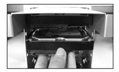
8 Attachez les disques durs à l'aide des vis de 5mm fournies. Utilisez 2 vis de chaque côté de chaque disque.
