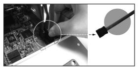
Placez le disque dur sur le tiroir, connecteur vers l'extérieur. Le disque du dessus est HDD1, suivi par HDD2, HDD3 et HDD4.
